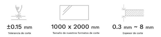
Las medidas de nuestros formatos de chapa coinciden con las medidas máximas que podemos realizar por pieza (1000 x 2000mm). Si necesitas más espacio para tus creaciones, contacta con nosotros.
